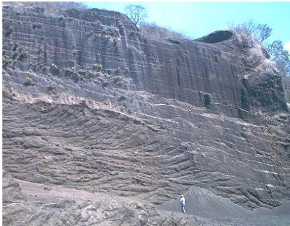
*Fotografía 8.15.- Desprendimiento de partículas de escoria en el frente de explotación del Cerro Redondo.*
