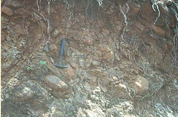
Fotografía 6.2.- Perfil de alteración de los basaltos-andesitas.
